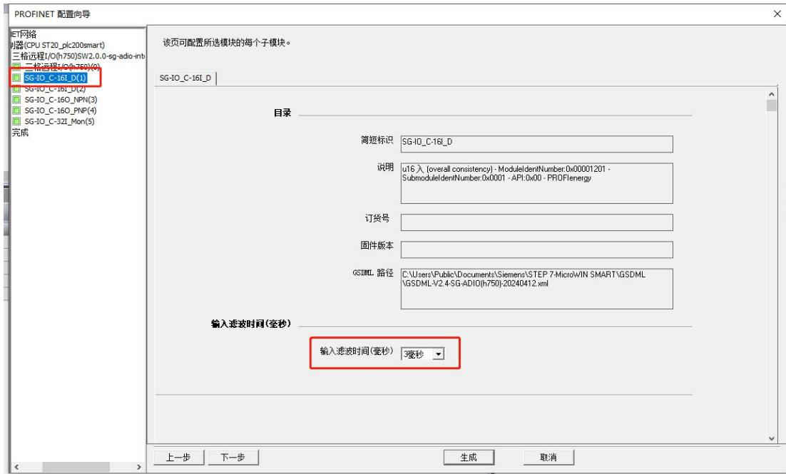
单击“SG-IO\_C-16O\_NPN/PNP\_x”可以设置设备离线时保持最后一次的输出值还是停止输出：
