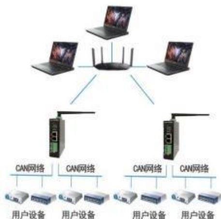
3、将一台 SG-CAN-WIFI 设置为 AP 模式，一台或多台 SG-CAN-WIFI 设置为 Station 模式，Station 模式的 SG-CAN-WIFI 接入 AP 模式的 SG-CAN-WIFI，可实现多个 CAN 网络之间的互联，如下图所示：
