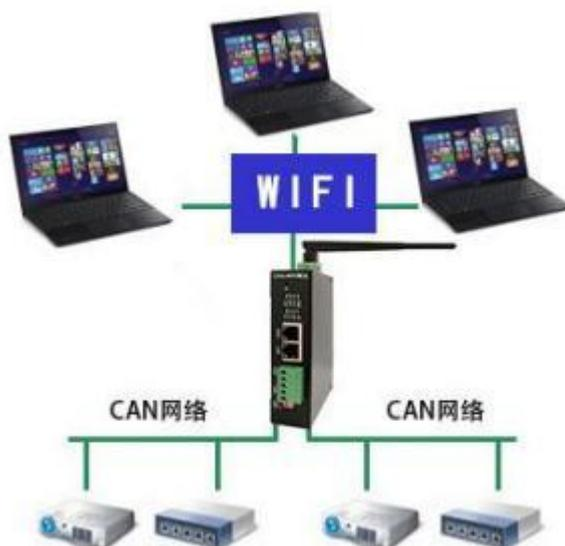
2、将一台或多台 SG-CAN-WIFI 设置为 Station 模式，接入无线路由器的 AP，可实现多个 CAN 网络之间的互联；如果笔记本、智能手机、平板电脑等也接入无线路由器的 AP，则可实现一台或多台网络设备与一个或多个 CAN 网络的互联。如下图所示：
