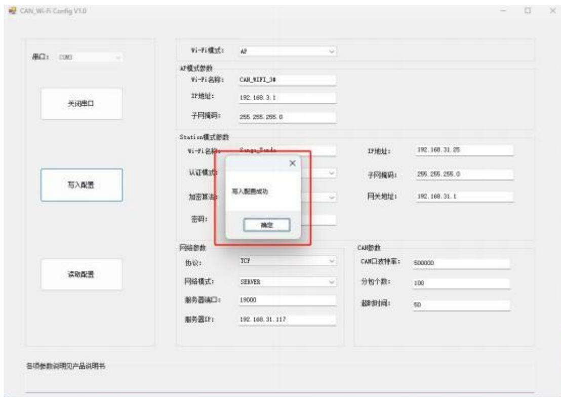
提示配置成功后，设备会自动重启，无需手动断电。
