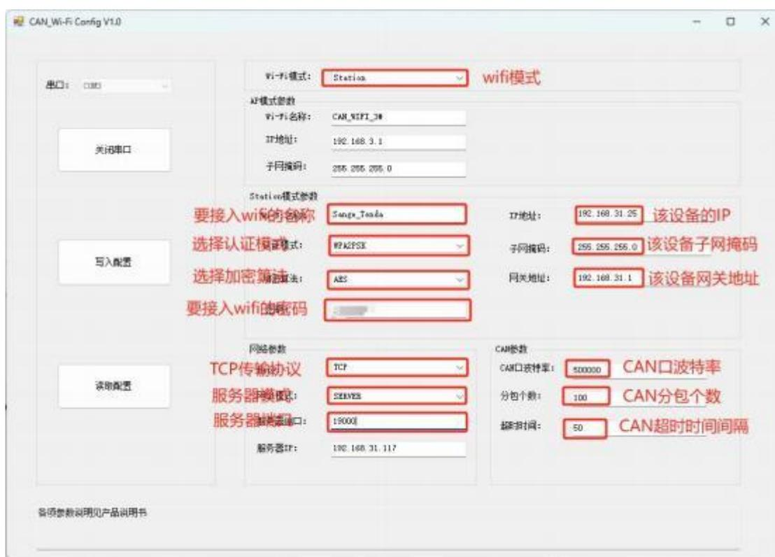
在 Station 模式下，上图红色框内的参数必须配置正确。
