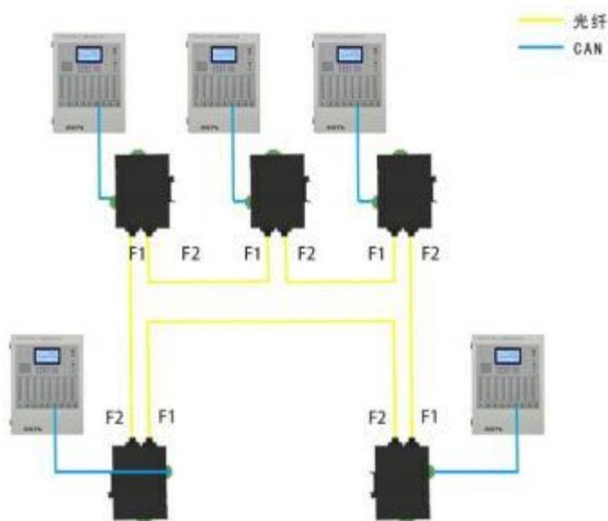
所有模块的 F1 接上一个模块的 F2，形成环形连接方式，如果环网光纤通畅则所有模块的 F1、F2 和 FC 灯常亮。
