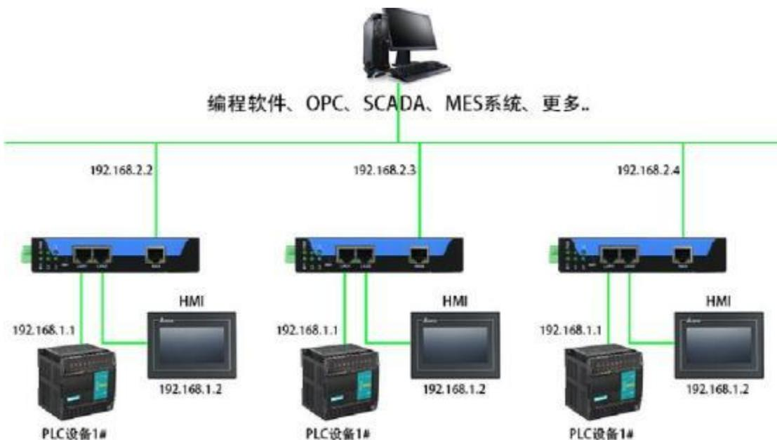
**注意：**主动发数据的网络模块接网关的 WAN 口，例如做 TCP 客户端的网络模块接网关的 WAN 口、做 TCP 服务器的网络模块接网关的 LAN 口。
