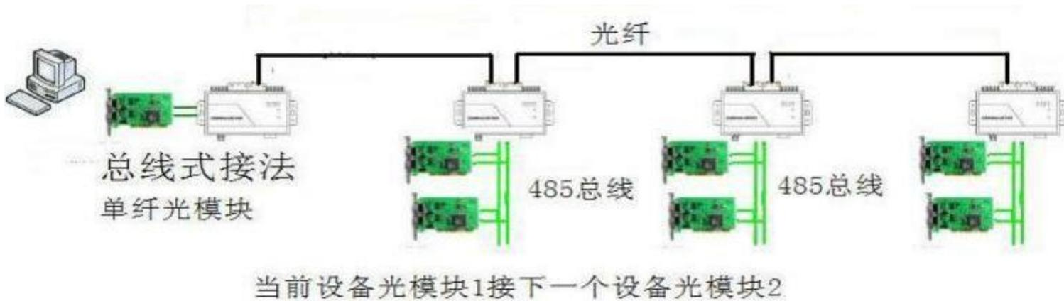
图 2 单纤总线式接法
