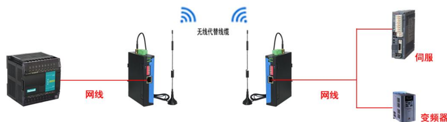
PLC和变频器/伺服之间的无线桥接示例
