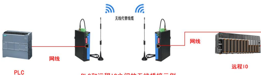
PLC和远程IO之间的无线桥接示例
