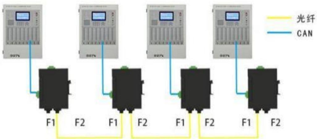
所有模块的 F1 接上一个模块的 F2，第一个模块的 F1 和最后一个模块的 F2 不连接，形成手拉手连接方式，如果光纤通畅，除第一个和最后一个外所有模块 F1、F2、FS 灯常亮，第一个模块 F2、FS 灯常亮、最后一个模块 F1、FS 灯常亮。
