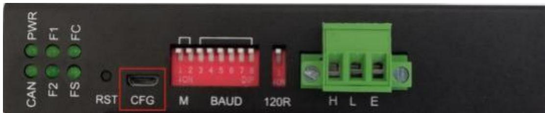
软件配置接口用来配置无法通过拨码开关配置的CAN 波特率，如果所用的CAN 波特率可以通过拨码开关配置则不需要通过软件配置。
